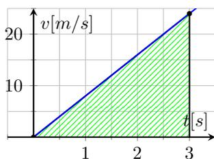
Analog zum Eingangsbeispiel mit dem Fahrradfahrer ist auch hier die Fläche unter der Geschwindigkeitskurve die zurückgelegte Distanz:
