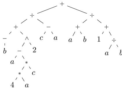
An der Wurzel des Baumes (zuerst), steht immer die Operation, die zuletzt ausgeführt wird. Diese Operation bestimmt über das «Wesen» des Terms, d.h. ob der Term letztlich eine Summe, Produkt etc. ist. Ausgewertet wird ein Baum wie folgt: Zuerst der linke Unterbaum, dann der rechte Unterbaum, dann die Operation der Wurzel mit den Resultaten der beiden Unterbäumen.
