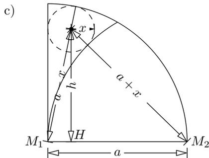
Die Höhe  $h$  kann auf zwei Arten berechnet werden, einmal im  $\triangle M_1HZ$  und einmal im  $\triangle HM_2Z$ :
