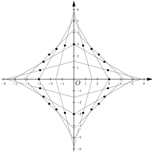
$M_{AB}$  ist der Mittelpunkt der Strecke  $[AB]$ , über der der Nullpunkt des Koordinatensystem ein rechter Winkel bildet. D.h.  $O$  liegt auf dem Thaleskreis über  $[AB]$  und somit  $\overline{OM} = \overline{AM_{AB}}$ .
