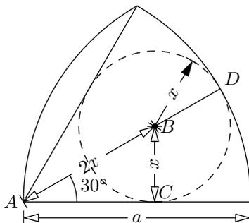
$\triangle ABC$  ist ein  $30^\circ$ - $60^\circ$  Dreieck und damit ist  $\overline{AB} = 2\overline{CB}$ . Weiter ist  $\overline{AD} = a = 3x$  und damit ist  $x = \frac{1}{3}a$ .
